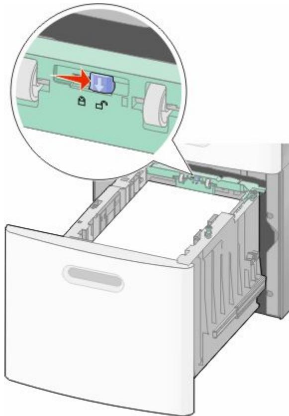
**4** 推长度导片释放销来升高长度导片，将导片滑动到与加载的纸张尺寸相符的正确位置上，然后锁定导片。
