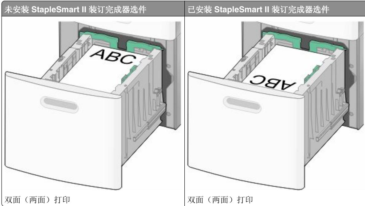
**注意：**请注意进纸匣侧面上的最高加载线，它指示加载纸张的最大高度。请不要过量加载进纸匣。
