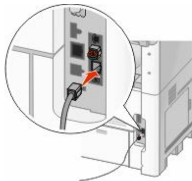
**3** 将电话线的另一端连接到活动的电话墙壁插孔的 N 槽中。
