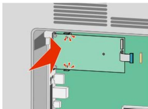
**8** 插入长的翼形螺钉并顺时针旋转使 ISP 固定到位，但是此时不要拧紧翼形螺钉。
