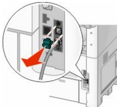
**4** 将另一条电话线连接到电话上，然后将它插入打印机的 **EXT** 端口
