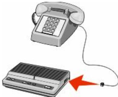
**5** 将第三条电话线从应答机连接到打印机的 EXT 端口
