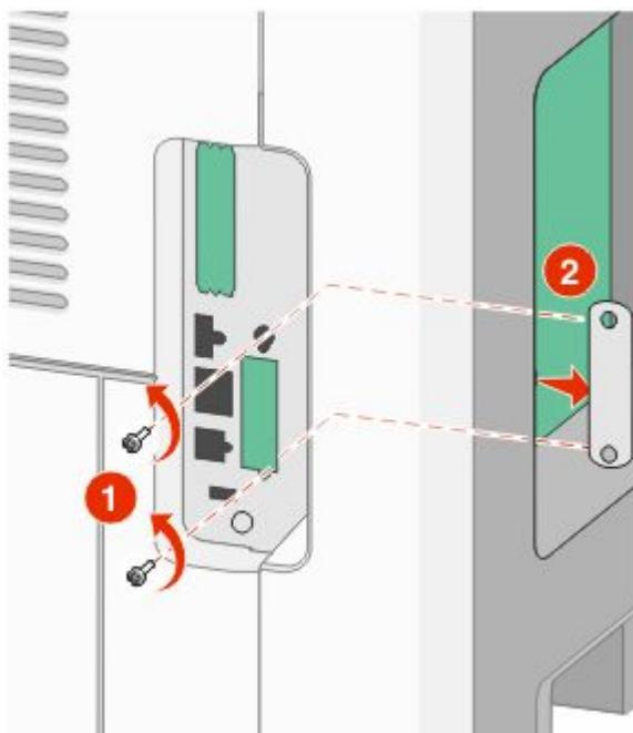
**4** 插入传真卡，然后安装提供的两个螺钉来固定传真卡固定支架。
