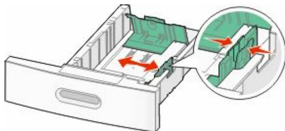
**3** 解锁长度导片，如图所示，向内压住长度导片凸柱，并将导片移动到与加载的纸张尺寸相符的正确位置上。
