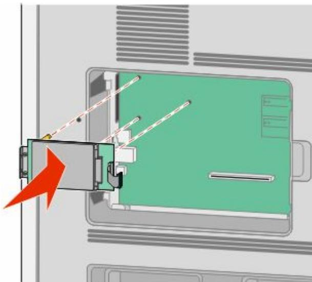
**b** 安装提供的两个螺钉以固定打印机硬盘固定板。
