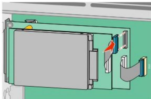
要将打印机硬盘直接安装到系统板上：
