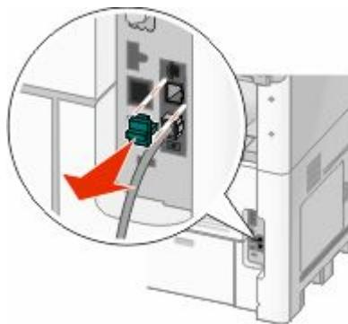
**4** 将第二条电话线从电话连接到计算机调制解调器上。
