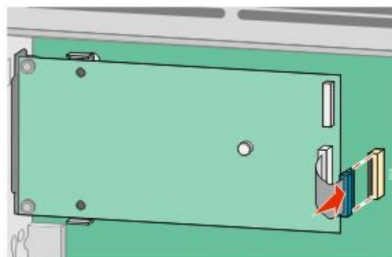
**12** 如果之前安装了打印机硬盘，则将打印机硬盘安装到 ISP 上。如需更多信息，请参阅第35页“安装打印机硬盘”。
