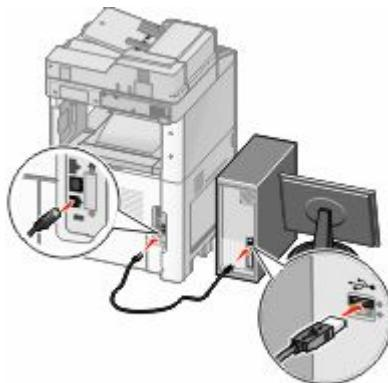
**注意:** 打印机被配置后, 软件将指导您断开临时的 USB 电缆连接, 这样您可以实现无线打印。
