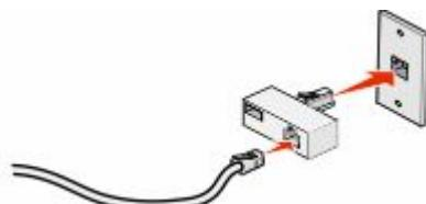
**注意：**图中所示为英国适配器。您的适配器可能有不同外观，但它将适合您所在地区使用的电话插座。
