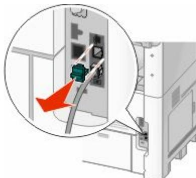
2 将电信设备直接连接到打印机后部的 EXT 端口
