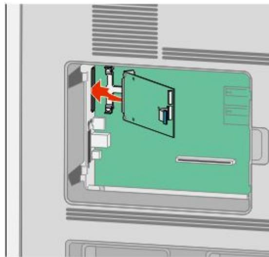
**7** 朝着塑料底座放低 ISP 直到 ISP 被固定在塑料底座的导轨之间。
