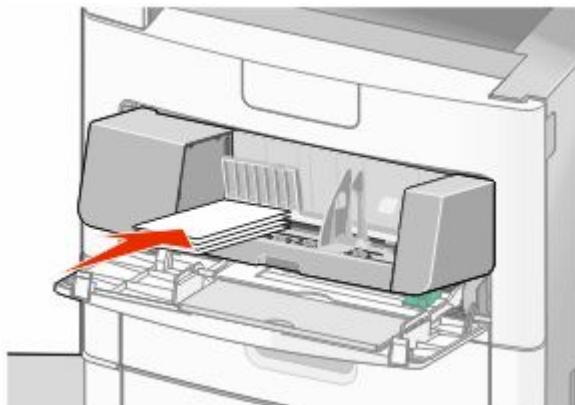
**注意：**不要通过用力将纸张压到纸堆高度限制器下面而超过最大纸堆高度。
