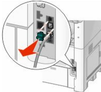
**注意：**一旦取下插头，如图所示，任何您通过适配器连接到打印机的国家或地区专用设备将不能正常工作。
