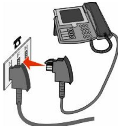
**5** 如果您想将相同线路用于记录应答机上的消息，请将第二条电话线（未提供）连接到应答机和电话墙壁插孔的另一个 N 槽中。
