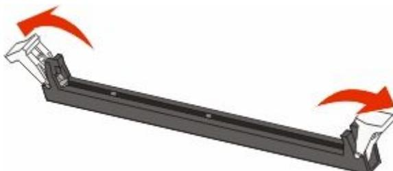
**4** 将内存卡上的槽口与连接器上的凸脊对齐。
