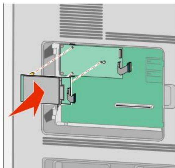
**c** 将打印机硬盘接口电缆的插头插入 ISP 的插座中。
