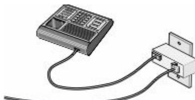
如果您的电信设备使用美式（RJ11）电话线，请按照下列步骤连接设备：
