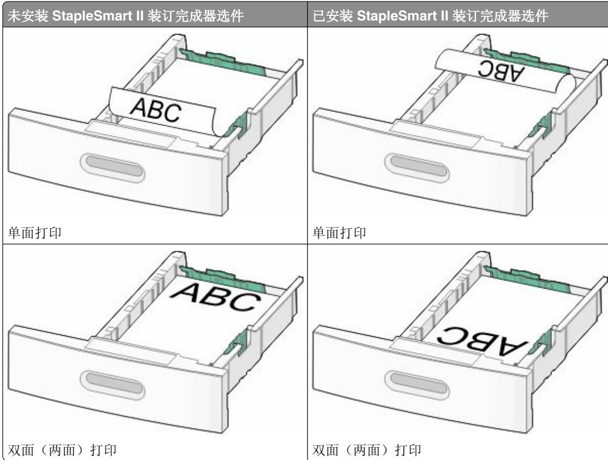
**注意：**请注意进纸匣侧面上的最高加载线，它指示加载纸张的最大高度。请不要过量加载进纸匣。
