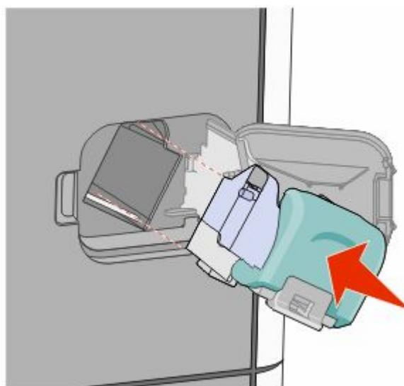
**7** 用力将订书钉盒托架推回到装订器部件中，直到订书钉盒托架发出“咔嗒”一声，卡入到位。
