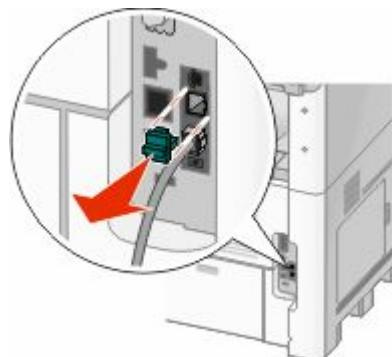
**4** 将第二条电话线从电话连接到应答机上。
