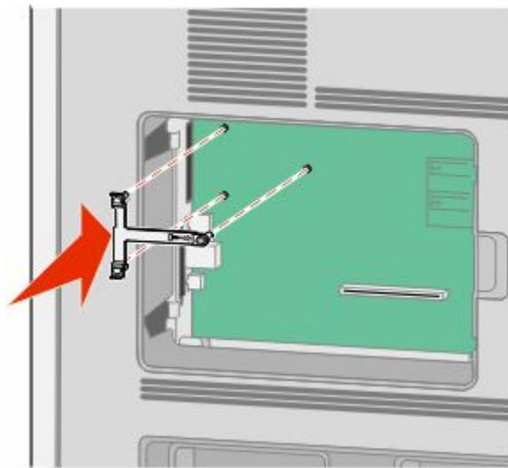
**6** 将 ISP 安装在塑料底座上。使 ISP 在塑料底座上面呈一定角度，然后靠近塑料底座，以便让任何伸出的连接器能通过系统板框架中的 ISP 开口。
