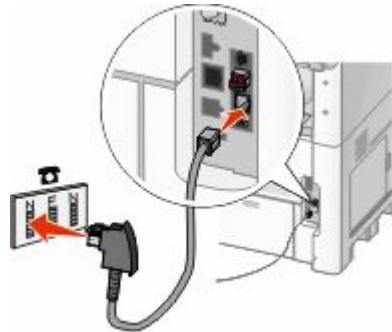
**4** 如果您想将相同线路用于传真和电话通信，请将第二条电话线（未提供）连接到电话和活动的电话墙壁插孔的 F 槽中。
